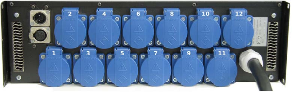
Рисунок П1.1 Внешний вид диммера. Задняя панель (Подключение нагрузки).
